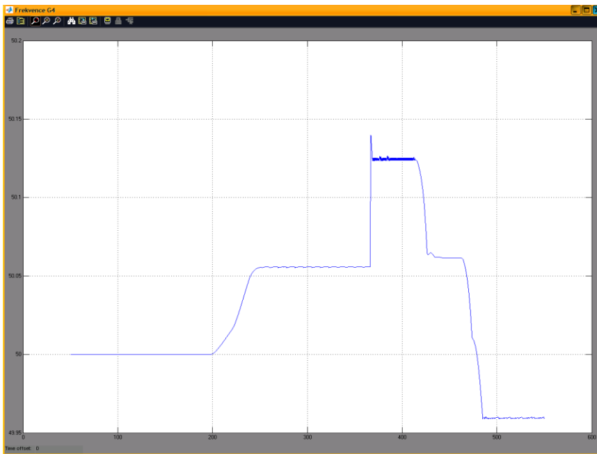
Obr. 11: Časové průběhy otáček generátoru G4 (změny v čase 115, 200, 360 s)
