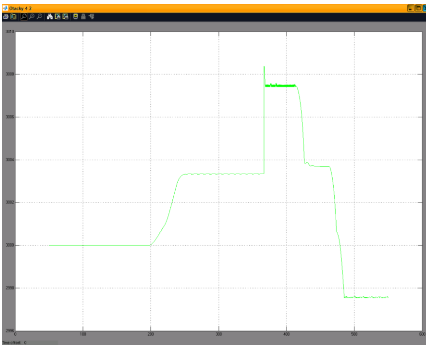
Obr. 12: Časové průběhy otáček generátoru G2 (změny v čase 115, 200, 360 s)
