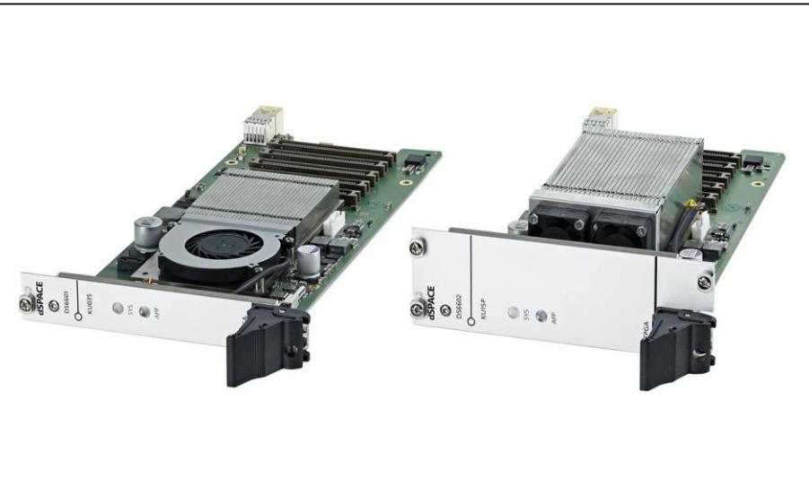
Vysokovýkonné FPGA karty vybavené najnovšou FPGA technológiou pre splnenie najprísnejších požiadaviek v širokom rozsahu aplikácií ako sú elektrické pohony, hybridné vozidlá, výkonová elektronika.
